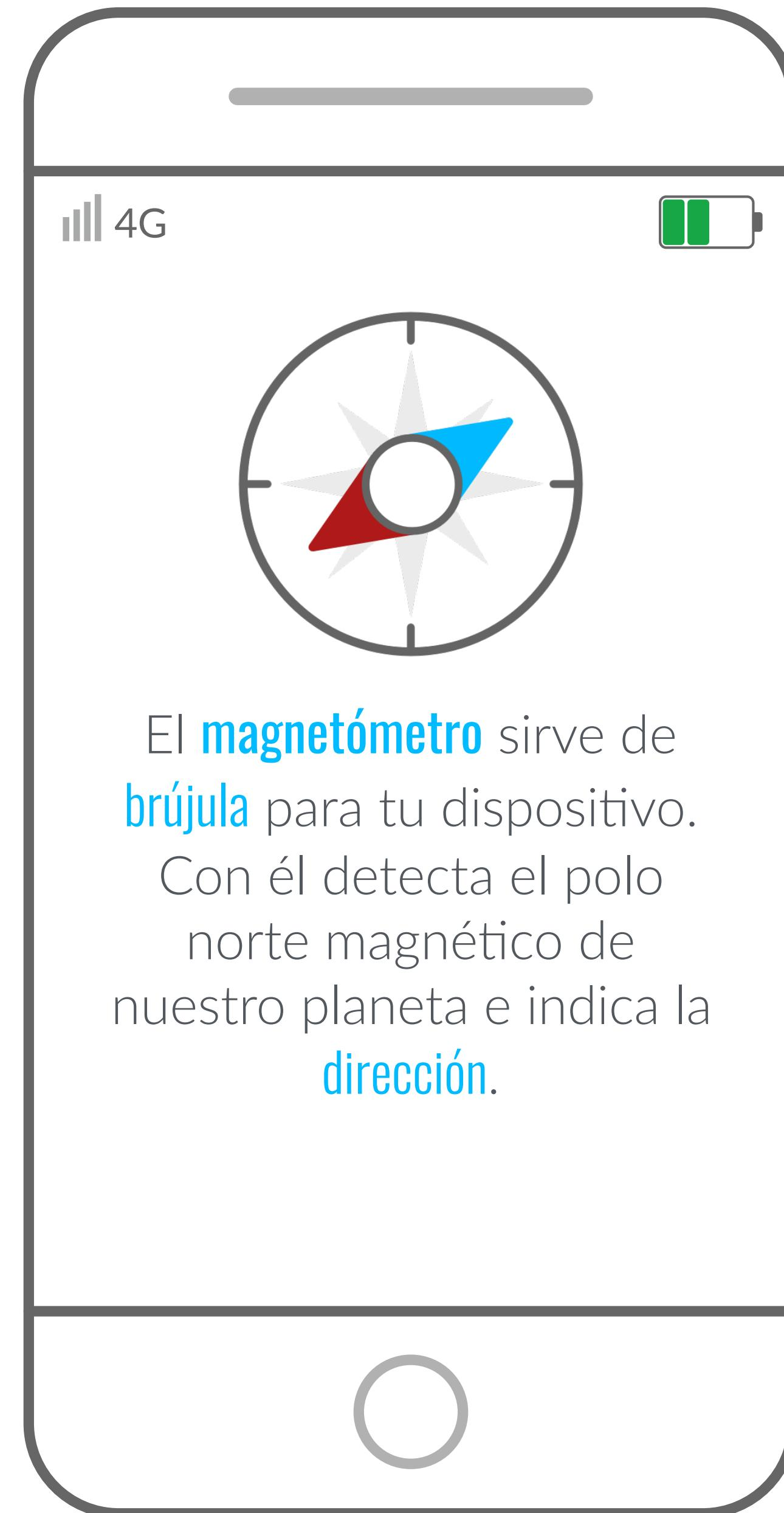
El **magnetómetro** sirve de **brújula** para tu dispositivo. Con él detecta el polo norte magnético de nuestro planeta e indica la **dirección**.
