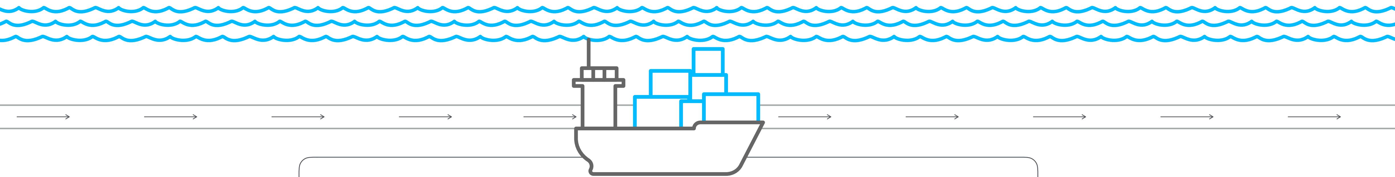
Para transportar y colocar los cables se precisan unos **barcos** específicamente preparados, que pueden llegar a albergar hasta **2.000 km**. Navegan a una velocidad de **1km/h** y cuentan con **equipamiento** para mantener su posición y resistir temporales y mareas.
